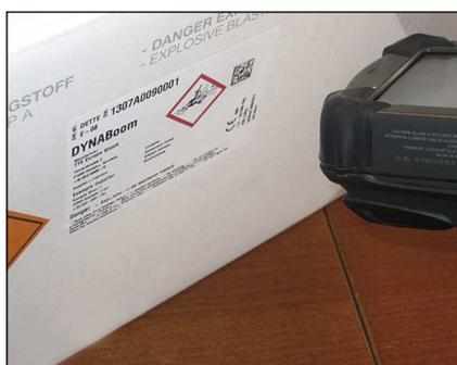
**Abb. 3:** Scannen eines Datamatrixcodes
